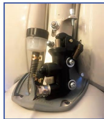
provvisoriamente il nasello e la mascherina, verificando che non ci siano punti di contatto tra i vari elementi. In particolare, è importante azionare il freno in modo da verificare che la leva della pompa idraulica non tocchi o sfregi contro la superficie interna del nasello. Dopo aver svolto tutte le necessarie prove/verifiche e gli eventuali piccoli spostamenti/aggiustamenti, completare
